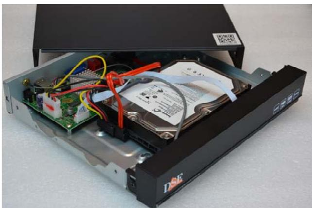
Fissa l'hard disk con le 4 viti fornite che si avvitano da sotto la base. Poi richiudi il coperchio.
