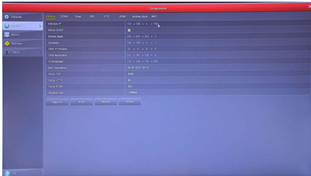
In questa finestra controlla che la spunta su DHCP sia attiva e prendi nota dell'indirizzo IP che il tuo NVR ha assunto all'interno della rete che è la prima voce in alto (nell'esempio 192.168.2.168. Ti sarà utile se vorrai accedere all'NVR dall'interno della tua rete, senza passare attraverso Internet.
